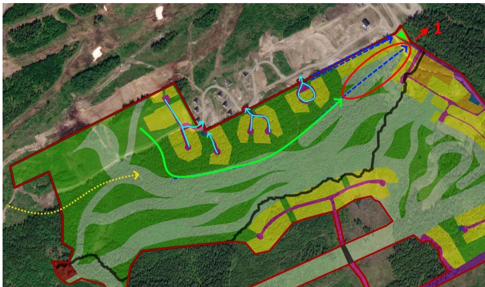
Figur 18. Funktionen av befintlig rinnväg/bäck (schematiskt markerad med blå streckad linje) i delområde 1 behöver bevaras, rinnvägen/bäcken leds under vägen via en trumma (trumma 1). Bakgrund: Ortofoto från Lantmäteriets visningstjänst.
