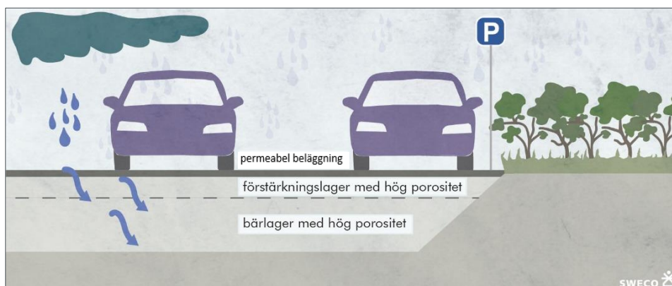
Figur 35. Principskiss på genomsläpplig beläggning under parkeringsytor. Figur: Sweco.
