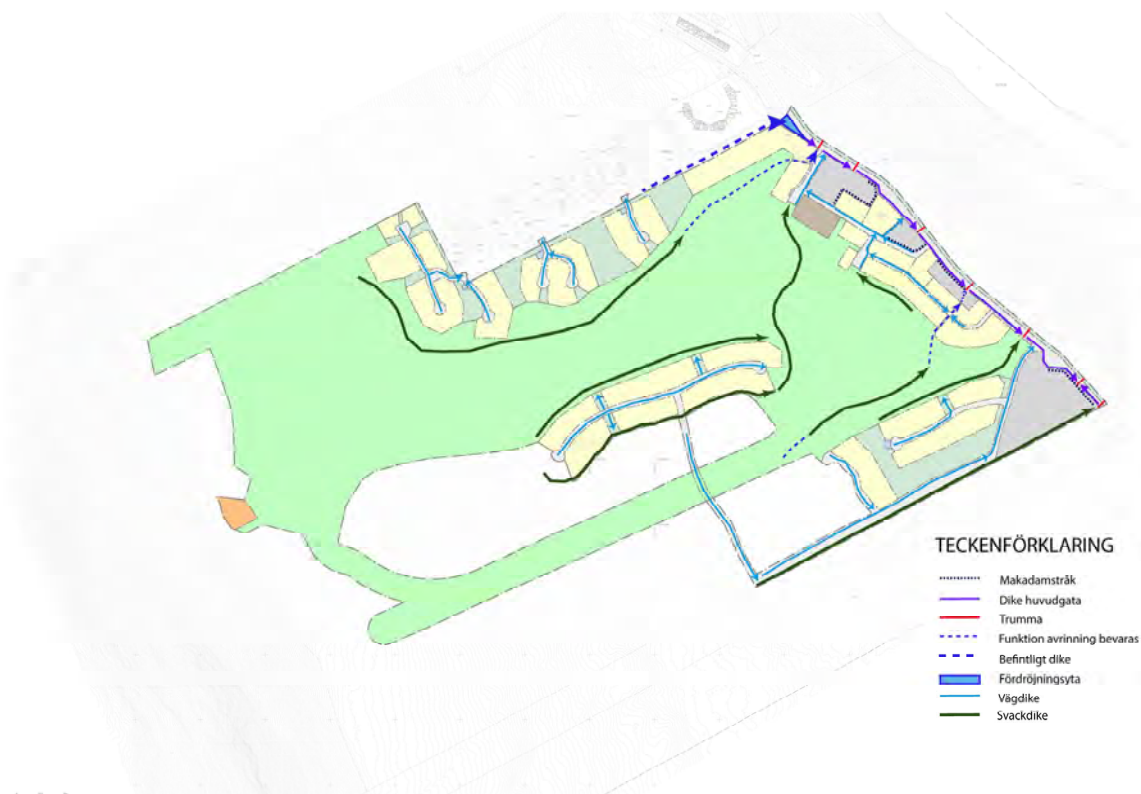
Figur 14: Illustration över föreslagen dagvattenhantering för området baserat på förslag i dagvattenutredningen (Sweco 2025).
